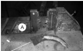
**FIG. 6.2** Atelier Reuse, matrices créées pendant la phase d'étude de la technique © Luc Reuse.
